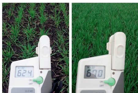
Рис. 2. Показания прибора N-tester на участках 1 (слева, 475 растений/м 2 ) и 2 (справа, 687 растений/м 2 ).
