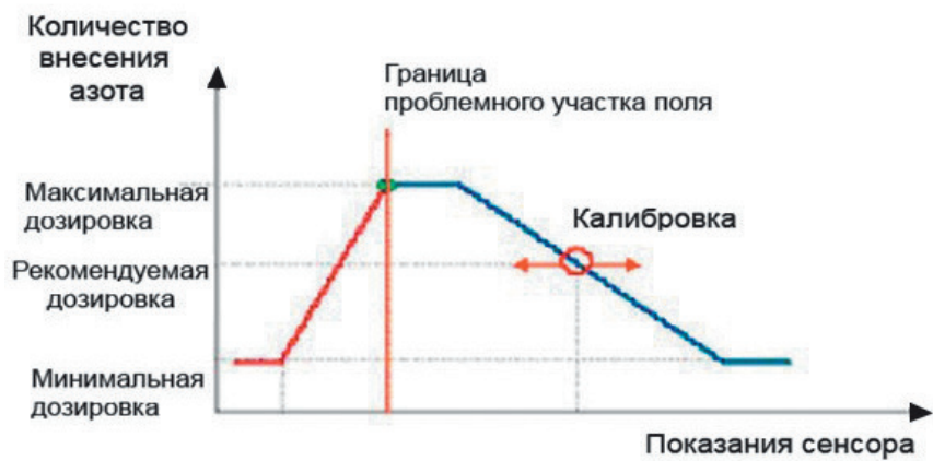
Рис. 4. Экспериментальный алгоритм внесения азотных удобрений на озимой пшенице по рекомендациям прибора N-tester в зависимости от биомассы посева.
