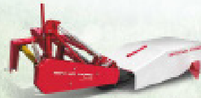
Косилки ротационные навесные STRIGE 2100/2400/2800 ширина захвата от 2,1 до 2,8 м производительность от 3 до 4 га/ч
