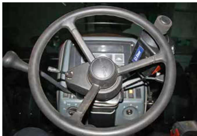
► Рис. 2. Подруливающее устройство EZ Steer
