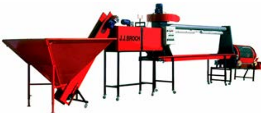
Рисунок 3. Линия по подготовке посевного материала чеснока фирмы JJ BROCH
